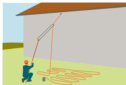
3 Système de corde à lancer pour installer les EPI contre les chutes en cas de travaux de courte durée (voir règle 8).
