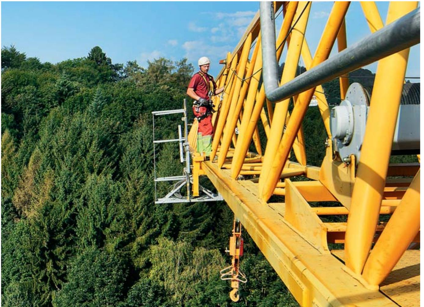
01 // Marco Spichtig n'a pas le vertige: l'amplitude du mouvement d'oscillation au sommet d'une grue exposée au vent peut atteindre un mètre.
