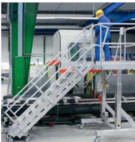
**02** // Plateforme de travail mobile. Si une installation doit être réparée, les endroits critiques doivent être accessibles en toute sécurité, par exemple avec une plateforme de travail fixe ou mobile.
