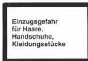
Bild 46: Warnung vor Restgefahren an gesicherten zugänglichen Einzugsstellen (Warnzeichen: Suva-Bestell-Nr. 1729/33; Zusatzzeichen: Suva-Bestell-Nr. 1729/71.d)
