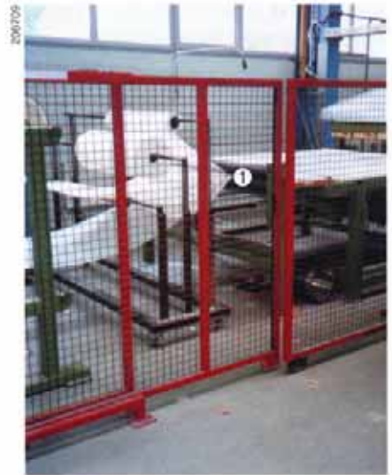
Bild 25: Kunststoff-Formanlage in einem Kunststoff verarbeitenden Betrieb. Der Gefahrenbereich aller bewegten Teile und die Einzugsstelle der Abzugwalzen (1) sind für den Normalbetrieb mit einem Schutzzaun und einer verriegelten «Zutrittsstüre» (verriegelte trennende Schutzvorrichtung) gesichert.
