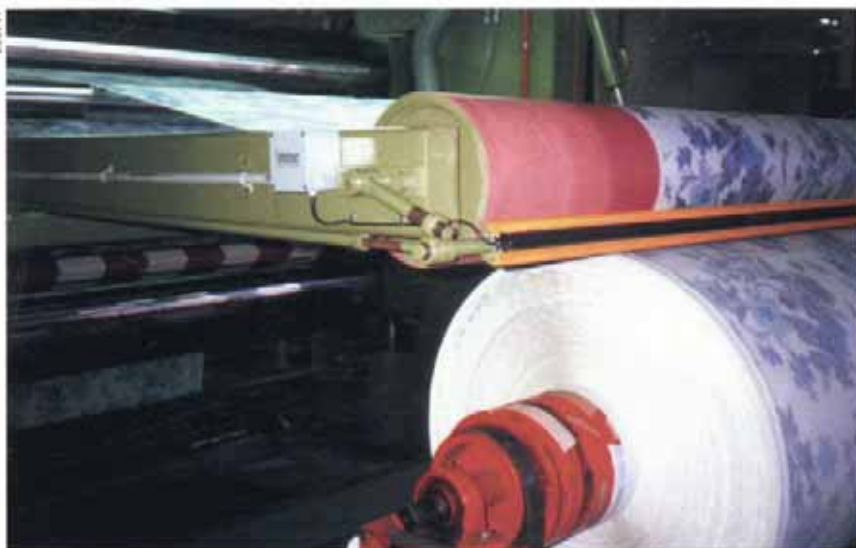
Bild 35: Dockenwickler zu Kalendar in einem Textilveredlungs-Betrieb. Die Einzugsstelle zwischen Antriebswalze (2) und Docke (3) ist für den Normal- und Sonderbetrieb durch eine gesteuerte Schutzstange, kombiniert mit einer Schaltleiste (1), gesichert. Beim Berühren der Schaltleiste wird die Antriebswalze abgeschaltet und automatisch von der Docke abgehoben.
