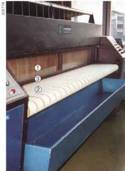
Bild 37: Mehrmulden-Glättmaschine in einer Wäscherei. Die Einlaufstelle zwischen der Walze (1) und den einlaufenden Gurten (2) in die Heizmulde ist mit einer Schaltklappe (3) gegen Zugriff gesichert. Beim Anstossen an die Schaltklappe werden die Gurten sofort stillgesetzt und die Walzen von den Heizmulden abgehoben. (Weitere Informationen über Schaltklappen siehe Abschnitt «Schutzeinrichtungen mit Annäherungsreaktion» auf Seite 18.)
