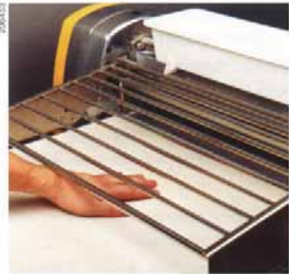
Bild 27: Teigausrollmaschine in einem Nahrungsmittelbetrieb. Die Einzugsstellen an den Walzen sind gesichert durch ein verriegeltes Schutzverdeck (Schutzgitter) mit Zuführöffnung.
