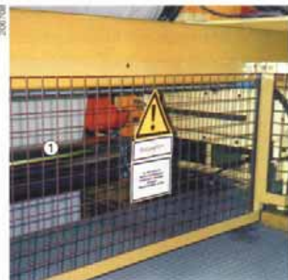
Bild 23: Abwickelstation an einer Beschichtungsanlage in einem Kunststoff verarbeitenden Betrieb. Die Einzugs- und Quetschstelle (1) an den Abzugwalzen ist verdeckt.
