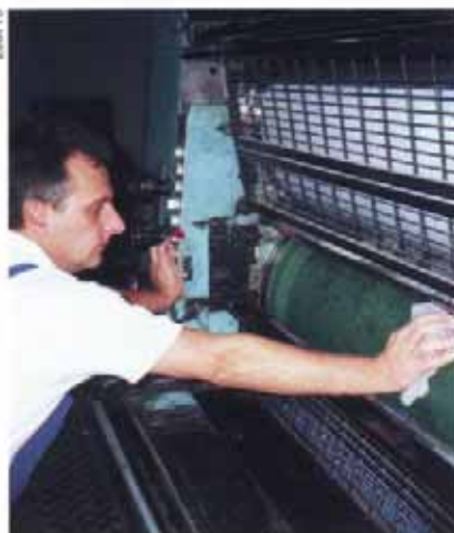
Bild 36: Offsetdruckmaschine in einem grafischen Betrieb. Das Schutzverdeck ist für den Sonderbetrieb geöffnet. Die Maschine läuft nur noch im Tippschrittbetrieb bei reduzierter Geschwindigkeit (Tippschrittbetrieb = Steuereinrichtung, die nur eine begrenzte Wegstrecke zulässt). Beim Anstossen an die Schaltstange (1) werden die Walzen sofort stillgesetzt.
