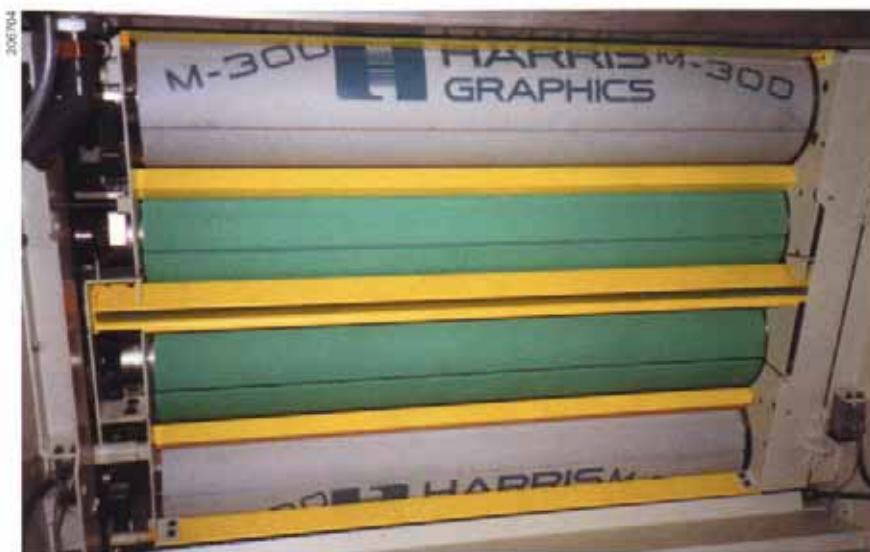
Bild 19: Rollenoffsetdruckmaschine in einem grafischen Betrieb. Walzen- bzw. Zylindereinlaufstellen sind mit Schutzstangen sowohl für den Normal- als auch für den Sonderbetrieb gesichert.
