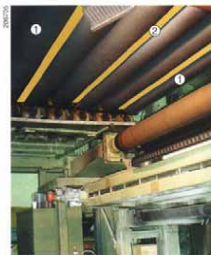
Bild 20: Kalander in einem Kunststoff verarbeitenden Betrieb. Die Einlaufstellen an den Kühlwalzen (1) sind mit der Hand erreichbar und deshalb mit Schutzstangen (2) gesichert.
