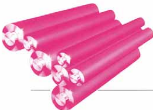
Bild 6: Walzenpaar mit einem Spalt von höchstens 120 mm zwischen den Walzen. Die Umfangsgeschwindigkeit der einen Walze ( V_1 ) ist grösser als diejenige der andern Walze ( V_2 ). Es besteht Einzugsgefahr für Finger, Hände und Arme.
