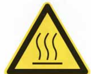
Bild 49: Warnung vor heisser Oberfläche. (Suva-Bestell-Nr. 1729/68)
