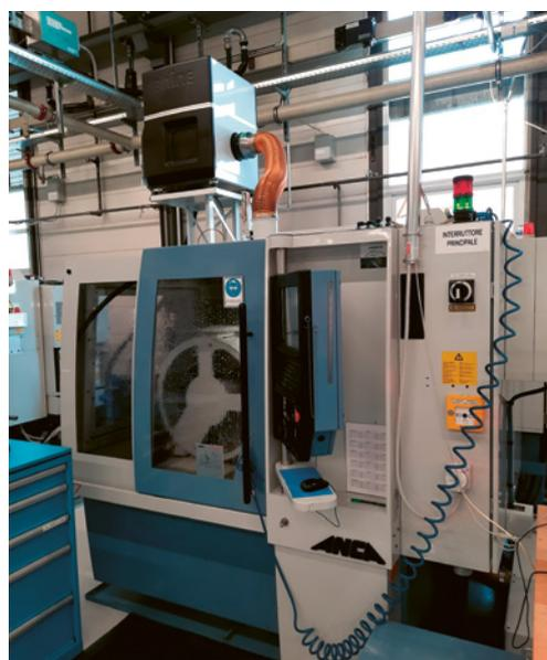
2 Machine capotée et munie d'une aspiration à la source avec un filtre électrostatique.
