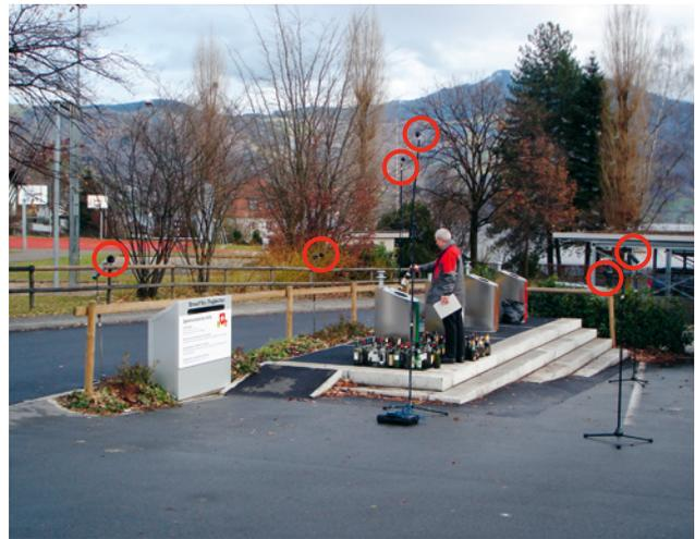
Fig. 16 Mesure du niveau de pression acoustique avec six microphones à proximité d'un poste de collecte de verre usagé. Les microphones sont signalés par des cercles.
