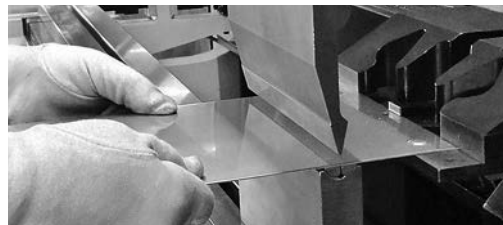
7 Position correcte des mains: pouce au-dessus de la tôle et le reste des doigts en dessous.
