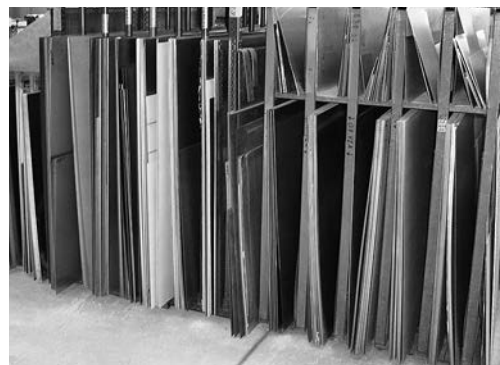
1 Tôles entreposées de façon sûre et ordonnée.
