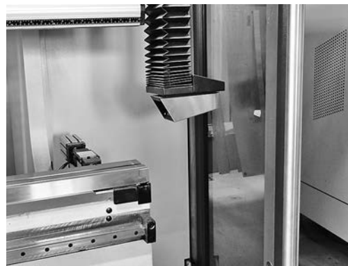
4 Dispositif de protection optique et porte de protection latérale. Il ne doit pas être possible de séjourner entre la porte de protection et l'outil.
