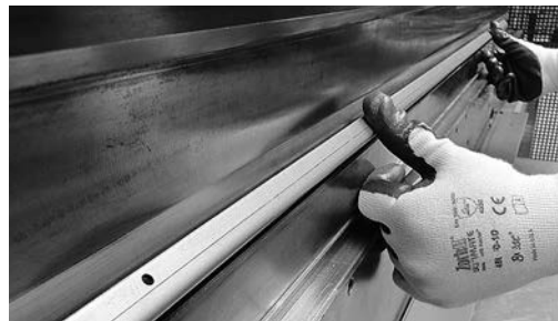
8 Position correcte des mains lors du deuxième pliage de la tôle.
