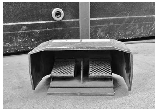
5 La cape de protection de la commande à pied permet d'éviter tout déclenchement intempestif.
