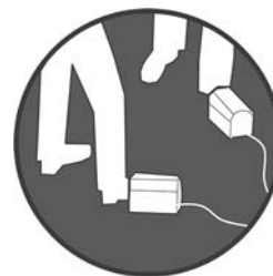
6 Chaque opérateur de presse-plieuse doit disposer d'une commande à pied de sécurité activée.
