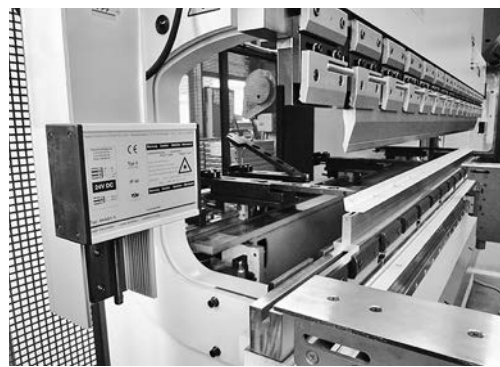
3 Dispositif de protection optique sur le tablier supérieur.
