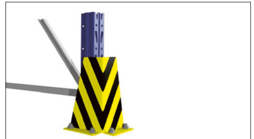
1 Protection contre les collisions au coin d'une étagère (hauteur minimale 400 mm; vissée au sol, non fixée à l'étagère).
