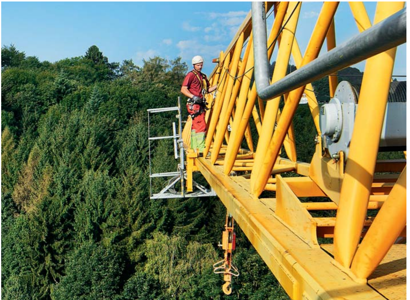
01 // Schwindelfreier Marco Spichtig: 40 Meter über dem Boden kann die Kranspitze im Wind bis zu einem Meter hin und her schwanken.
