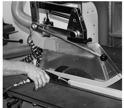
5 Riduzione del rumore e protezione contro la penetrazione di aria nel corpo usando ugelli appropriati.
