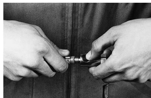
4 Allacciamento di sicurezza. Staccando il raccordo, il raccordo stesso non è più sottoposto a nessuna pressione di condotta, il che permette di evitare i colpi di frusta dei tubi flessibili.
