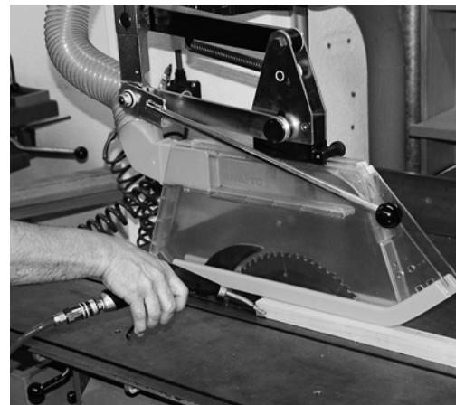
5 Réduction du bruit et protection contre la pénétration d'air comprimé dans le corps grâce à une conception adéquate de la buse. La figure présente une buse à canaux multiples peu bruyante.
