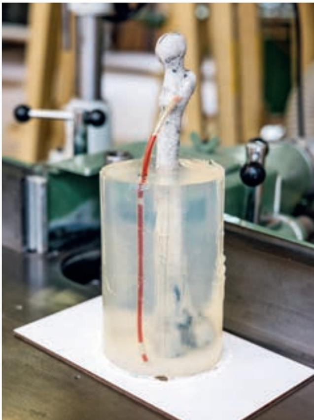
Timo Schneider a utilisé de la gélatine, un os en plastique et du sirop de framboise pour simuler une cuisse.
