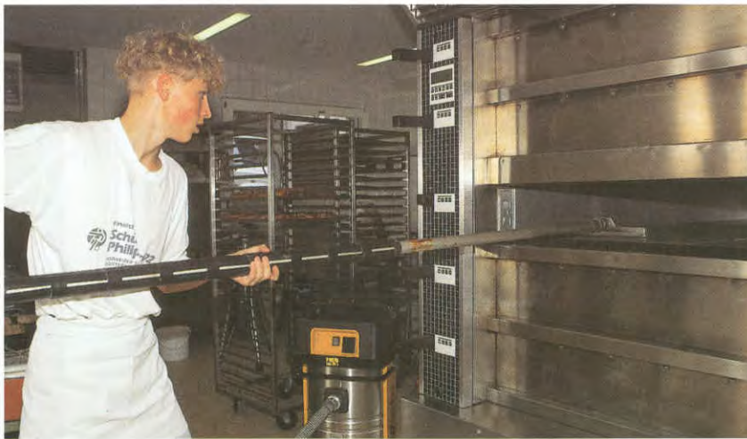
Bild 13 Ofenreinigung mit Staubsauger
