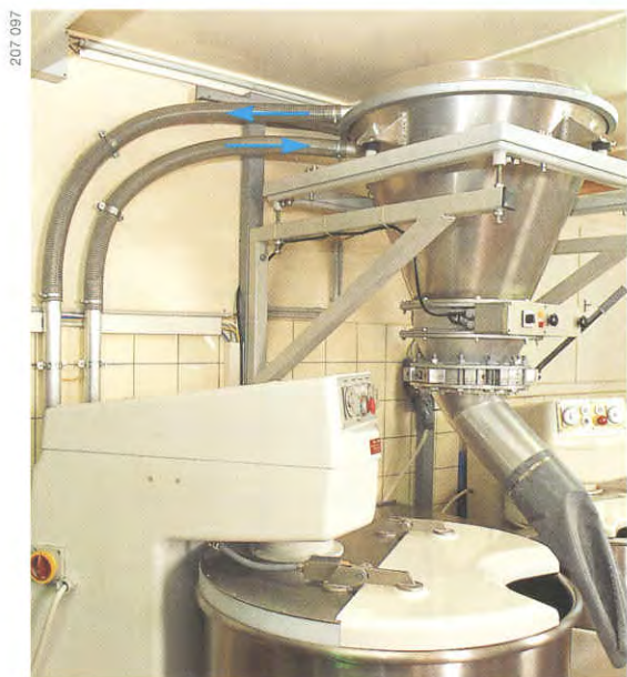
Bild 19 Mehltransport durch Saugpneumatik
