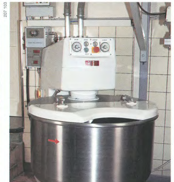
Bild 24 Knetmaschine mit geschlossenem Verdeck
