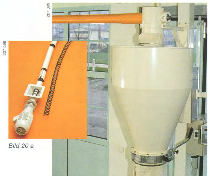
Bild 20 b Bild 20 a + b: Mehltransport durch Spiralförderer
