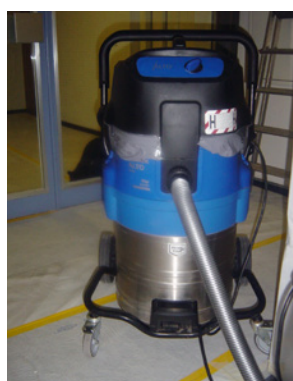
2 Industriestaubsauger mit Filter für Staubklasse H (Asbest)
