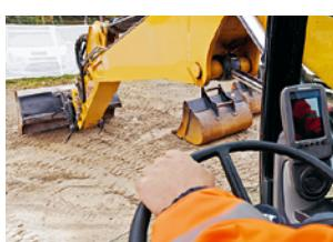
**Ziel:** Die Maschinisten haben beim Wechseln der Werkzeuge und Anbaugeräte immer freie Sicht darauf. Zeitbedarf Instruktion: 5 Min.
