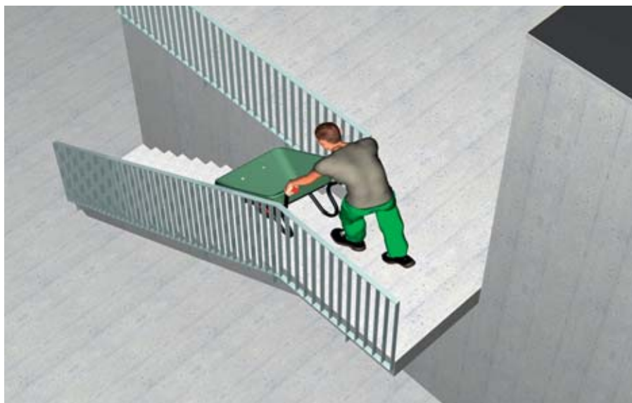
01 // Une zone du palier était dépourvue de protection latérale. Cette lacune a causé la mort d'un travailleur. // Suva
