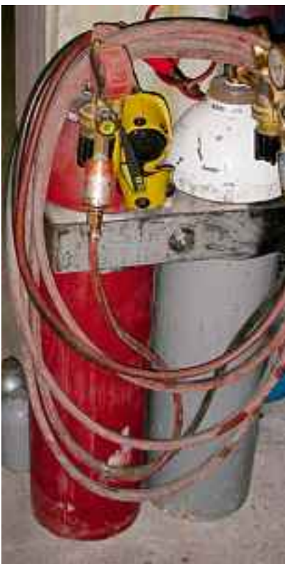
Fig. 7: acétylène et oxygène font partie du soudage autogène.
