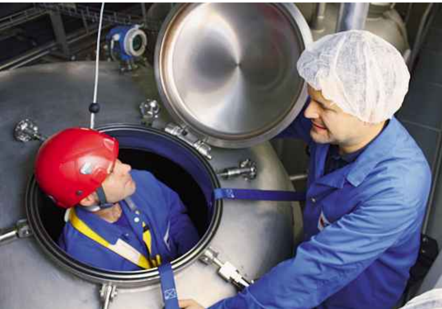
Les travaux de maintenance dans des citernes ou des silos ne doivent être exécutés qu'à deux avec un équipement de protection approprié.
