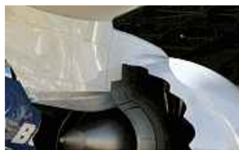
Nuisance sonore plus faible grâce à des lisières en zigzag aux conduits d'échappement du groupe de propulsion (Boeing 787).
