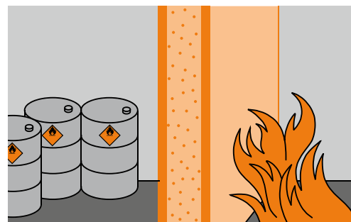
3 Schutz der Behälter gegen übermäßige thermische Einwirkung.
