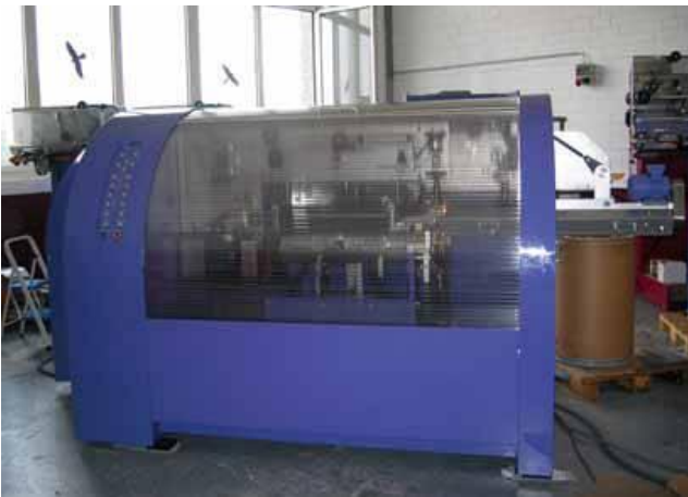
21 Saldatrice automatica incapsulata. Grazie all'incapsulamento il livello sonoro esterno viene ridotto a 82 dB(A).
