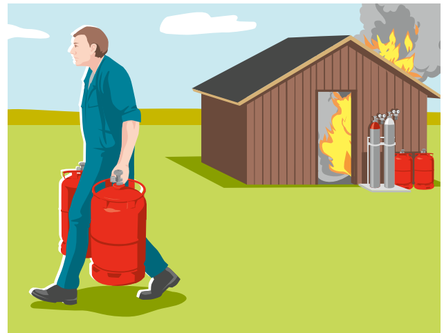
2 Gasflaschen aus dem Gefahrenbereich entfernen oder, falls dies nicht möglich ist, kühlen.
