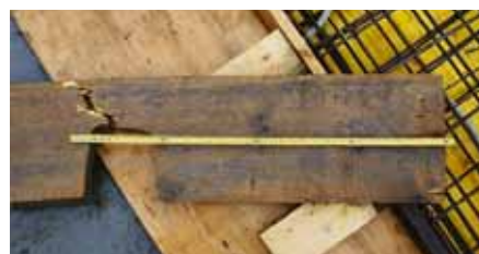
03 // La plinthe cassée (largeur: 28 cm) avait été partiellement sciée. // Photo: Suva
