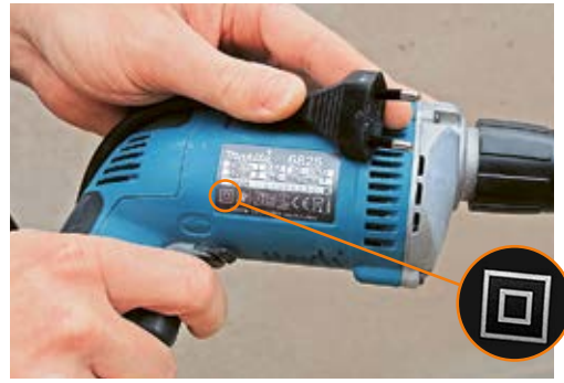
1 Perceuse appartenant à la classe de protection II avec marquage correspondant.
