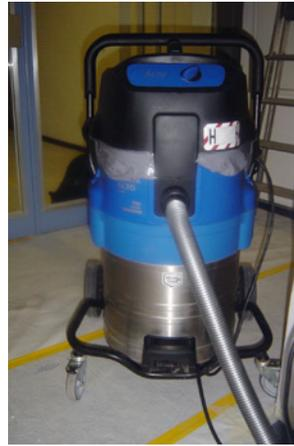
4 Staubsauger mit Filter für Staubklasse H gemäss EN 60335-2-69 mit Zusatzanforderung Asbest
