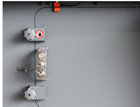
4 Porte di accesso con interruttore di finecorsa e sistema di sicurezza a chiave interbloccata. In questo modo si evita che terzi possano riavviare la macchina.
