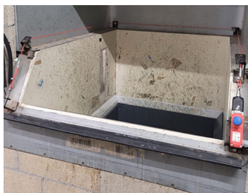
3 Alimentazione diretta manuale con ulteriori misure di protezione
