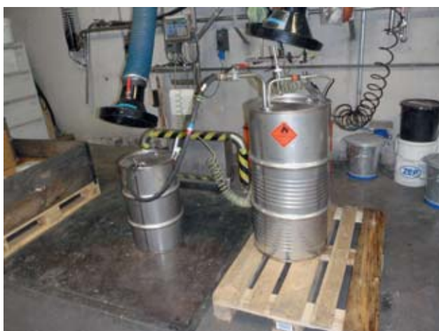
26 Mise à la terre des récipients (transfert de solvant par mise en surpression d'azote)
