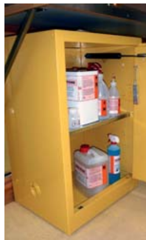
21 Armoire destinée au stockage de petites quantités de liquides facilement inflammables dans les ateliers
