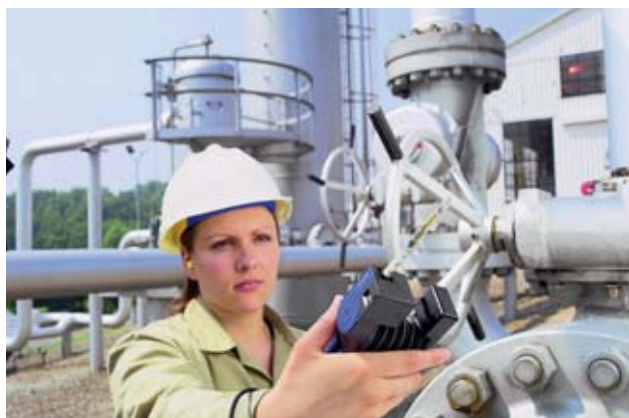
27 Mesure de la concentration de substances toxiques au moyen de tubes réactifs colorimétriques
