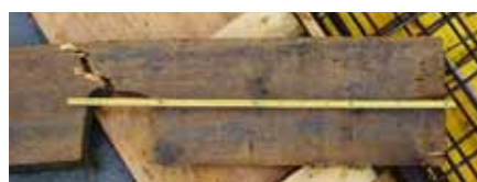
03 // Das zerbrochene Gerüstbrett (Breite: 28 cm) mit der verhängnisvollen Aussparung. // Bild: Suva
