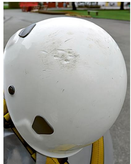
3 Auch dieser sichtbar beschädigte Helm muss ersetzt werden.
