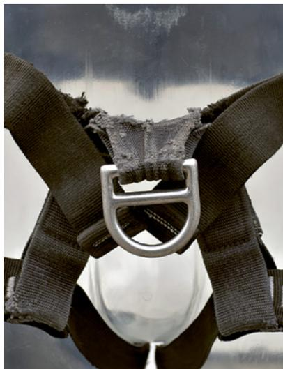
2 Dieser stark beschädigte Sitzgurt muss ersetzt werden.
