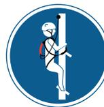
3 Positionierungssystem: Positioniert den Benutzer an der Arbeitsstelle. Ein freier Fall wird verhindert. Sehr geringes Verletzungsrisiko.
