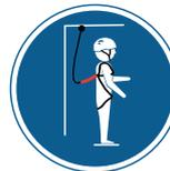
4 Sturzauffangsystem: Richtig angewandt, fängt es den Benutzer bei einem Absturz auf. Der Fangstoss wird mit einem Falldämpfer begrenzt. Verletzungsgefahr nicht ausgeschlossen.
