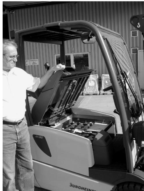
5 Soulèvement du couvercle des coffres pour éviter l'accumulation de gaz explosibles au cours de la charge.
