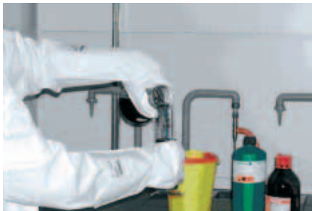
Figure 2 Gants en tissu laminé offrant une résistance de longue durée à la pénétration des produits chimiques
