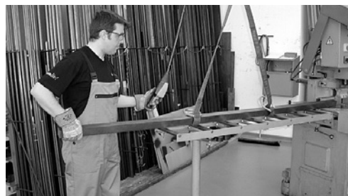
2 Palan pour transporter les barres lourdes jusqu'à la scie.
