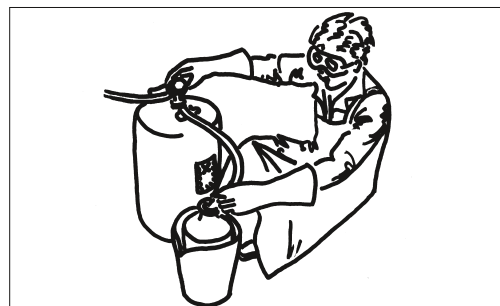
6 Travaso con pompa a mano
