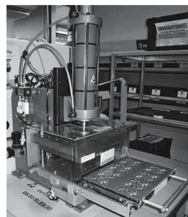
Fig. 9: protection par le dispositif d'alimentation (déclenchement de la frappe lorsque le dispositif d'alimentation est fermé, largeur de la fente max. 6 mm)
