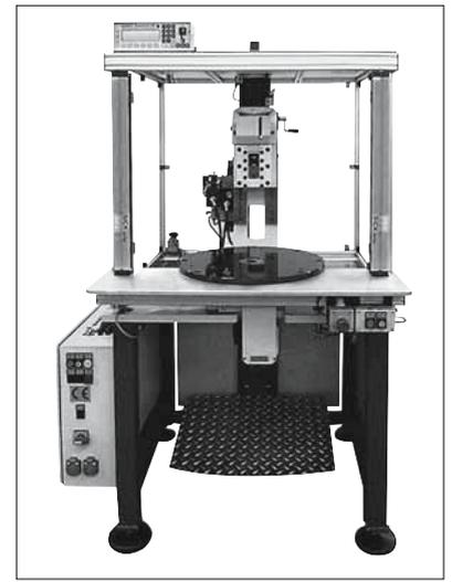
Fig. 7: presse équipée d'un barrage immatériel.
