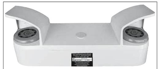
Fig. 3: les boutons-poussoirs de la commande bimanuelle doivent être équipés de collettes ou protégés d'un actionnement involontaire.
