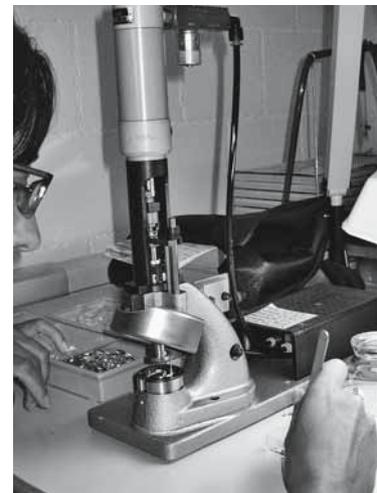
Fig. 8: déclenchement de la frappe par l'abaissement de l'écran de protection (verrouillage direct dans le circuit pneumatique).
