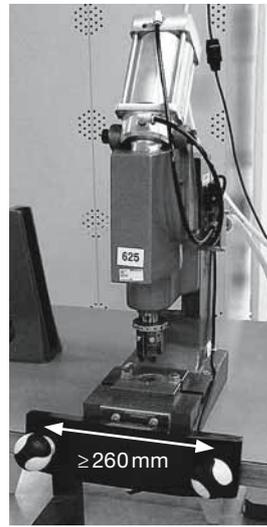
Fig. 6: commande bimanuelle avec au moins 260 mm de distance entre les boutons-poussoirs.
