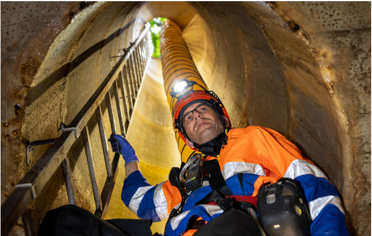
10 Kontinuierliche Messung der Atmosphäre mit einem mobilen Gaswarnmessgerät.
