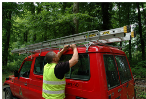
3 Messa in sicurezza del carico sul veicolo
