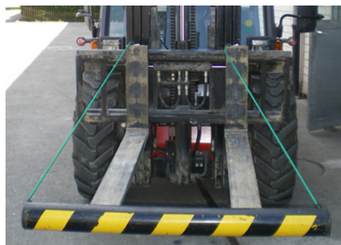
4 Per la circolazione sulle strade pubbliche le forche devono essere protette con l'apposita barra a strisce.
