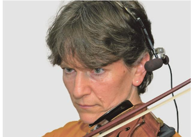
52 Microphone fixé sur un arceau utilisé pour mesurer la charge sonore à proximité de l'oreille d'une musicienne en train de jouer
