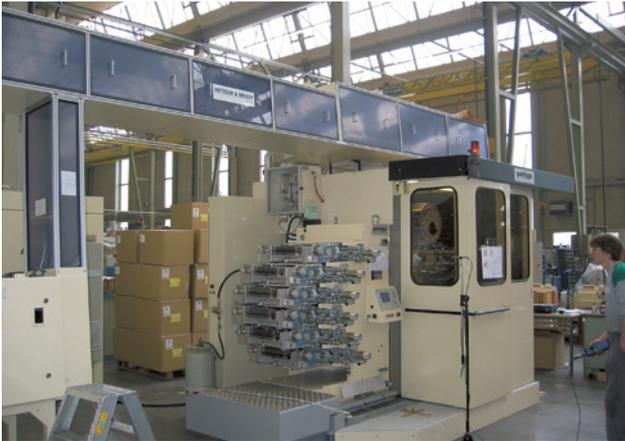
**70** Encoffrage partiel d'une machine d'impression de tubes (200 tubes/min); on mesure à 1 m de distance encore un niveau sonore de 77 dB(A).
