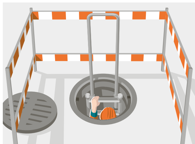
1 Sicherer Zugang zu einer Schachtleiter mit Ein- und Ausstiegshilfe
