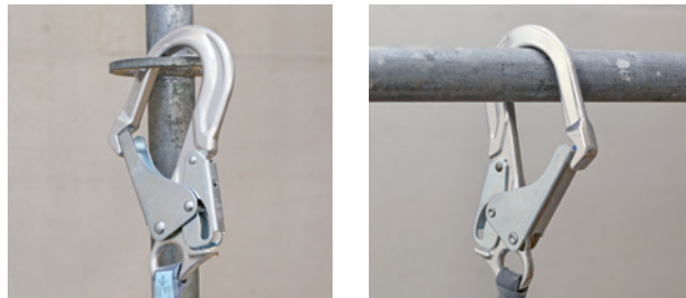
5 et 6 Les mousquetons doivent être fixés verticalement et ne pas être sollicités transversalement.
