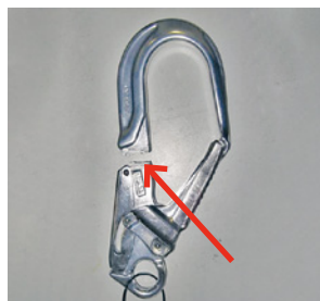
7 Les mousquetons sollicités transversalement peuvent céder et entraîner une chute.
