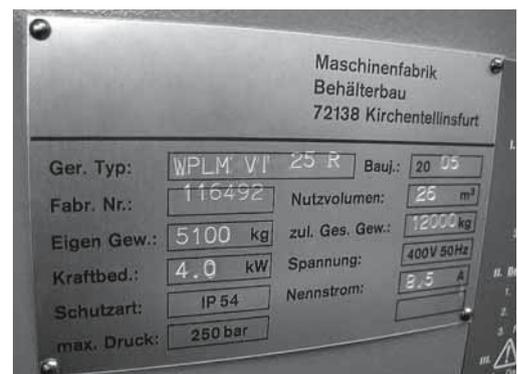
Bild 3: Typenschilder, Lastangaben, Hydraulikschläuche usw. nie mit Farbe überstreichen.
