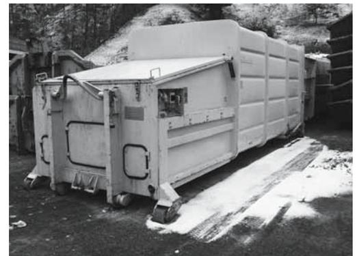
Bild 6: Spezialbehälter. Die Hydraulik und die elektrische Installation müssen durch eine Fachperson instand gehalten werden.
