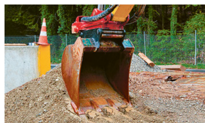
3 Fare il test di contropressione per i sistemi di attacco rapido
