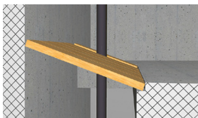
2 Petite ouverture près d'une paroi fermée par des planches encastrées
