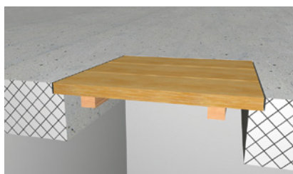
1 Petite ouverture fermée par des planches posées en surface
