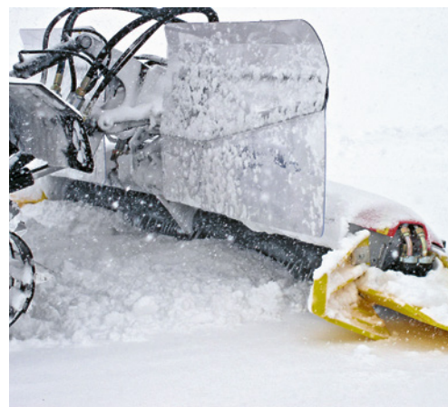
5 La fresa posteriore deve essere spenta quando qualcuno si avvicina al veicolo.
