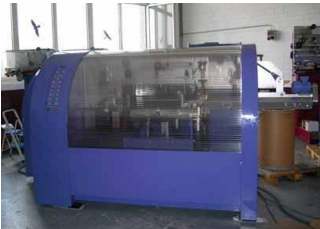
21 Encoffrage d'une machine fabriquant des boîtes de conserve. Le niveau sonore sur la partie externe de la machine a été réduit à 82 dB (A).
