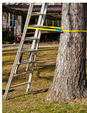
1 Échelle attachée avec une sangle au pied de l'arbre
