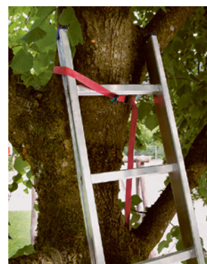
2 Échelle attachée avec une sangle dans les houppiers
