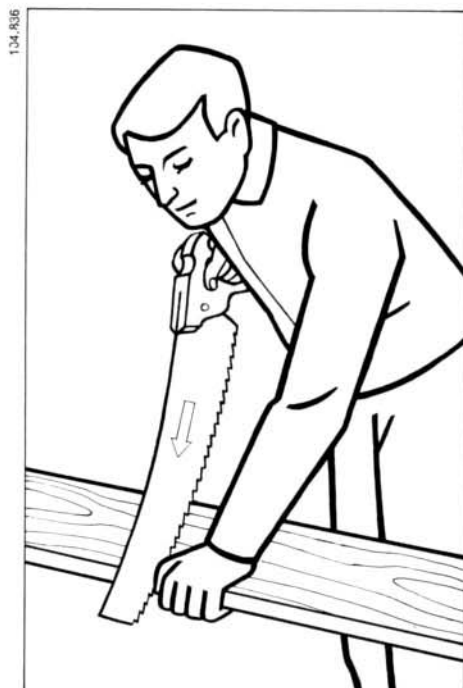
Figure 64 faux Ne jamais commencer de scier en poussant la scie en avant. Le pouce se trouvant à proximité de la lame pourrait être blessé.
