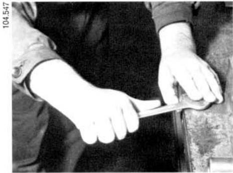
Figure 51 juste Pour serrer ou desserrer des boulons et écrous, agir si possible par traction sur la clef. Il est recommandé d'utiliser des clefs fermées (clefs polygonales). Au besoin la clef sera assurée avec la main contre le glissement.
