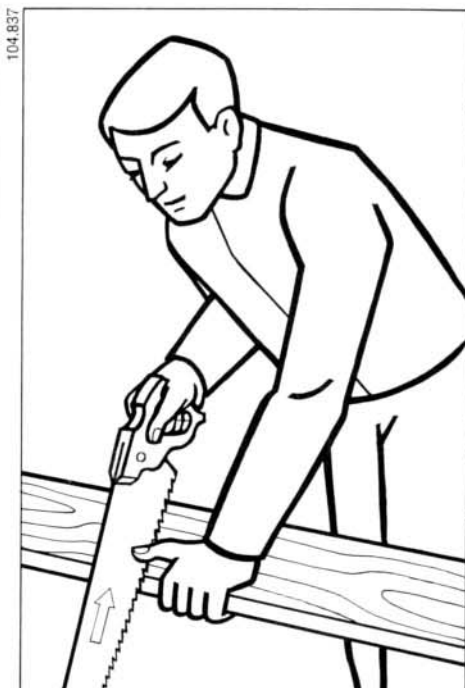
Figure 65 juste Tirer la scie lors de la première entaille. Tendre le pouce et le tenir aussi loin que possible de la denture de la lame. Vers la fin de la coupe, diminuer la pression sur la scie.
