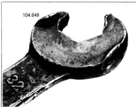
Figure 55 faux Clefs endommagées. Elles doivent être mises au rebut.
