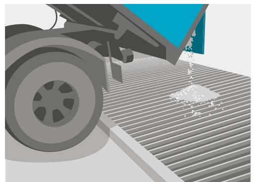
10 Apertura di alimentazione provvista di griglia non destinata al passaggio del personale. La distanza tra le sbarre longitudinali non deve superare gli 80 mm. In caso di presenza di sbarre longitudinali e trasversali, le aperture tra le sbarre devono essere al massimo di 150x150 mm.
