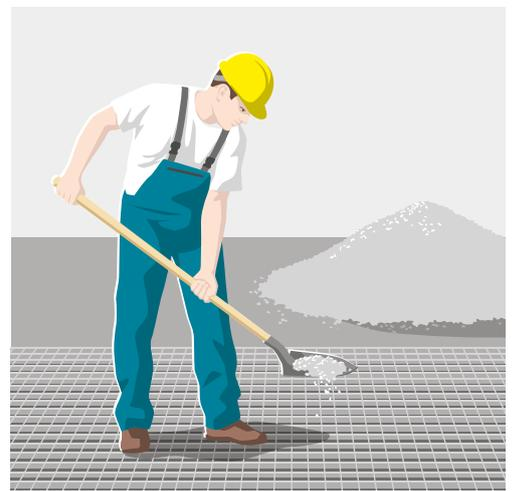
9 Apertura di alimentazione provvista di griglia per il passaggio del personale. Le maglie della griglia devono misurare al massimo 50x50 mm.
