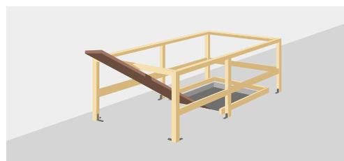
4 Se si è rinunciato al corrente intermedio e alla tavola fermapièdi per movimentare del materiale, il parapetto sul lato aperto deve distare dall'apertura nel vuoto almeno 0,5 m. L'altezza del parapetto dev'essere di massimo 1,2 m.
