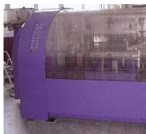
Encoffrage d'une machine
