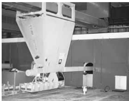
Figure 26: Installation de centrifugation de tuyaux armés de fibres de verre après mise en place d'un cloison de séparation.
