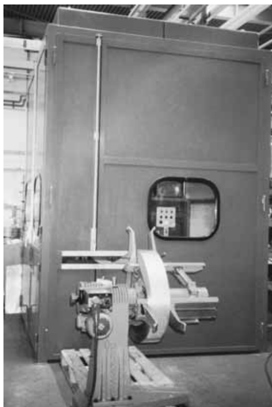
Figure 32: Enceinte d'une presse automatique à découper (au premier plan, on peut reconnaître le dévidoir d'alimentation des feuillets).
