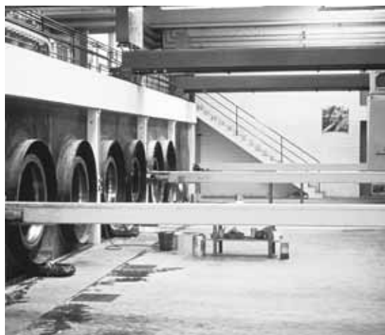
Figure 25: Installation de centrifugation de tuyaux armés de fibres de verre sans enceinte.
