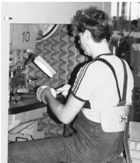
Figure 27: Presse à découper à excentrique munie d'une enceinte partielle. La conduite de la machine n'a pas été rendue plus difficile par cette mesure.
