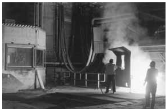
Figure 30: Cabine de commande (à gauche) d'un four électrique (à droite).
