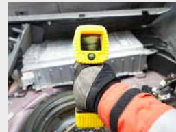
Zustand der Hochvolt-Batterie auf mechanische Beschädigung überprüfen und Wärmeentwicklung mit Wärmebildkamera festhalten.
