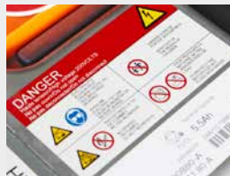
Beispiel eines Warnklebers auf einem Hochvolt-Energieträger
