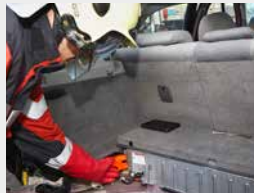
Spannungsfrei schalten (wenn möglich gemäss Herstellangaben oder Rettungskarte), z.B. Hochvolt-trennschalter von Batterie entfernen.
