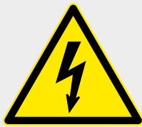
Warnung vor gefährlicher Spannung: Kennzeichnung von Hochvoltssystemen.
