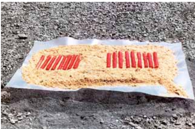
Figura 6: incenerimento su un letto di sabbia con foglio di plastica e segatura
