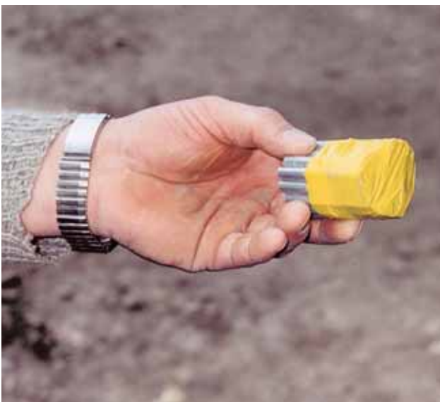
Figura 1: l'apertura della capsula detonante è sigillata con nastro adesivo.
