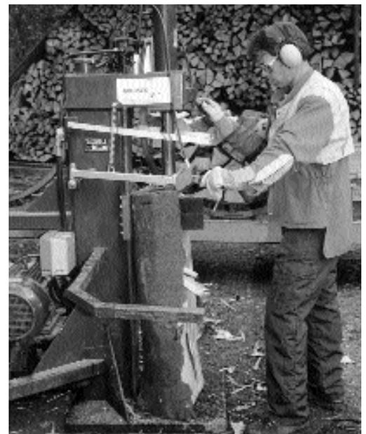
Figura 3: Macchina spaccalegna verticale con comando a due mani e raschiatore. Il cuneo fenditore viene disinserito automaticamente quando il raschiatore rimane bloccato dall'inceppamento del pezzo di legno.
