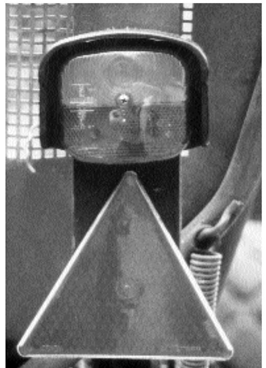
Figura 5: Supporto per catadiottri retroriflettenti, retroriflettori, luce di coda/dispositivo d'avvertimento a luce lampeggiante.
