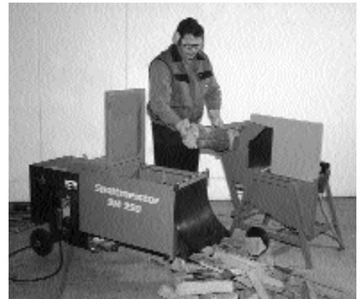
Figura 2: Macchina spaccalegna orizzontale per legno corto con organo di taglio schermato e chiuso a chiave.
